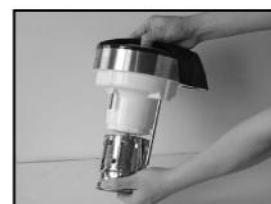
取拉法尔网按照安装指示箭头方向装好，拉法尔网口部与下盖配合处应紧密无缝隙，安装完毕后，用手向下拉一下，拉法尔网不动，说明安装到位。
