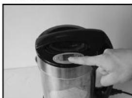
将机头按正确的位置放入杯体中，插上电源线，“Joyoung九阳”指示灯亮，按“选择”键选择“玉米”功能，这时“玉米”指示灯一闪一闪的亮，再按“启动”键，“玉米”指示灯常亮，启动玉米程序。
