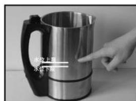
请将水加至上、下水位线之间（本机具有无水防干烧功能，如杯体内无水或水位过低，机器不会工作，以保证使用安全。您若想缩短制浆时间，可以加入70度以下的温水制作米浆）。
