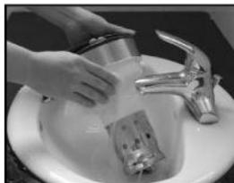
1、机头：请用水轻轻洗去机头下部粘附的豆浆或其他东西，切勿将机头浸入水中，也不要用水清洗机头上部，以防止机头进水，发生短路现象。
